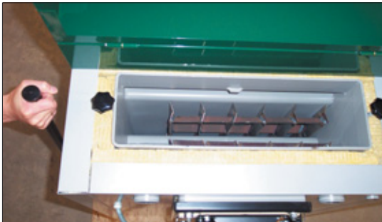
Abb. 7: Plattenwärmetauscher mit Kratzblechen, die zur Reinigung mittels Hebelvorrichtung hin und her bewegt werden
